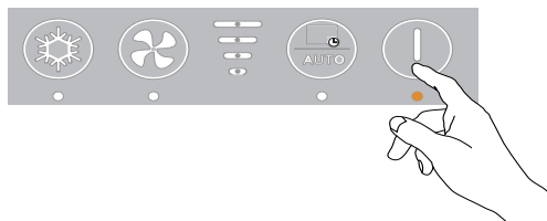
Sl. 4: Zaustavitev alarma filtra
